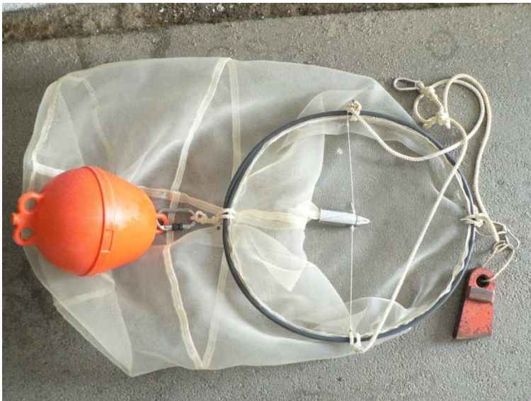
PHOTO 1. - Le filet, équipé d'un enregistreur de distance.
